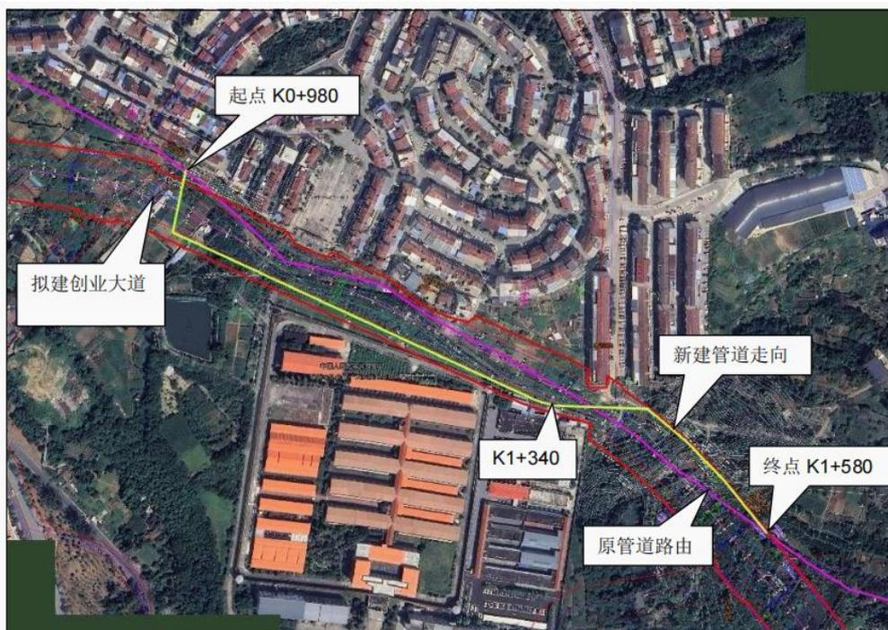
图 2-2 迁改管线走向图
