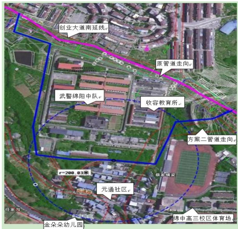
图 2-5 方案二迁改后管道高后果区识别示意图
