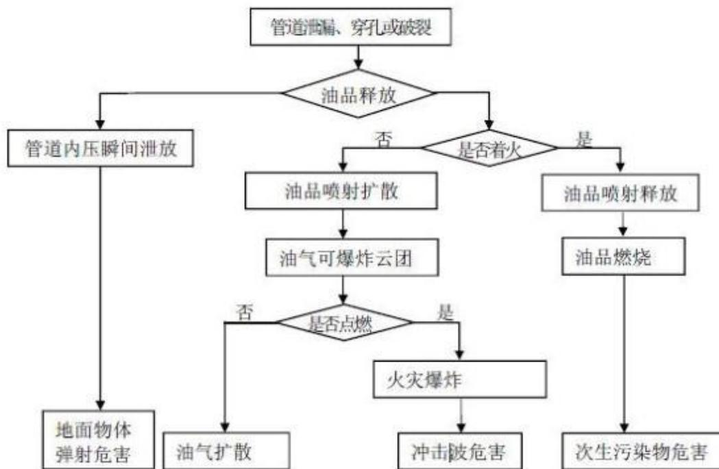
图 5-2 管道事故树分析示意图
