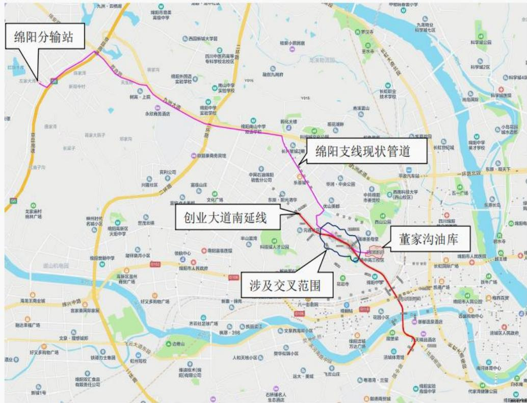
图 2-1 兰成渝成品油管道绵阳支线现有管道与创业大道南延线宏观走向图
