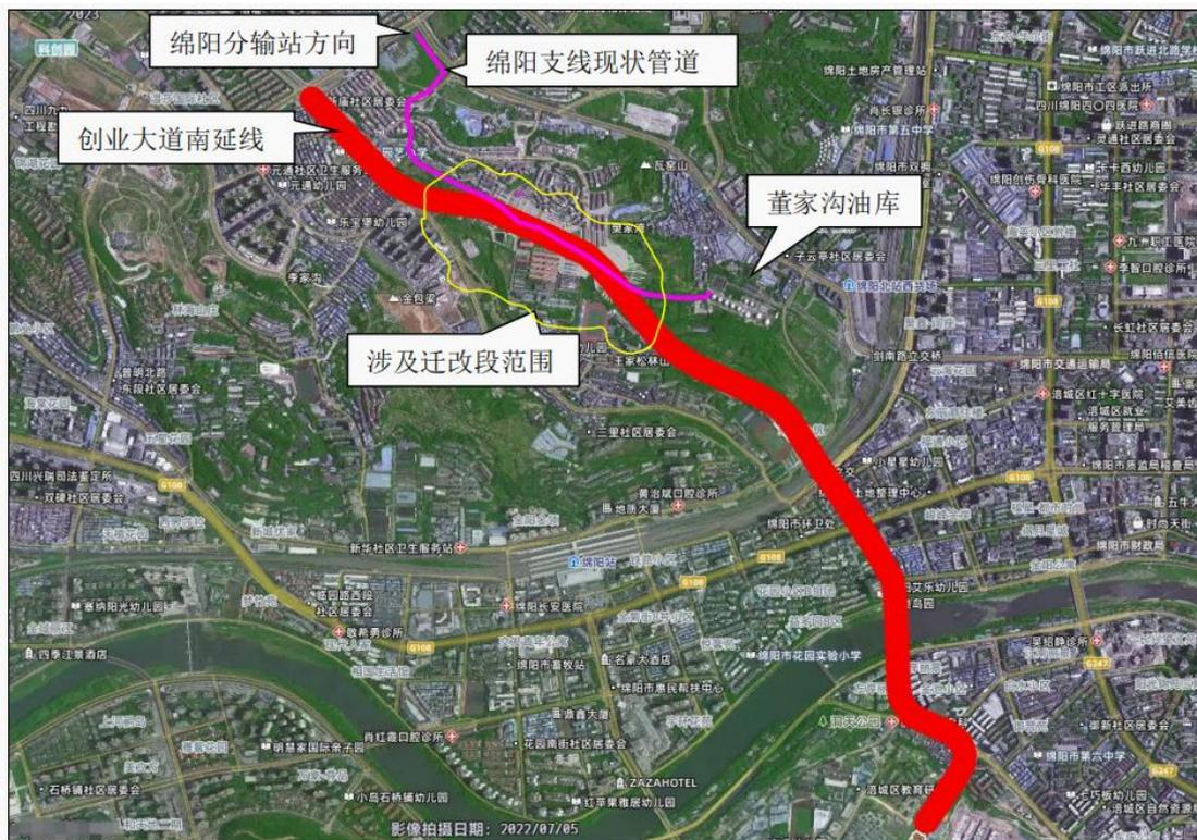
图 1-1 兰成渝成品油管道绵阳支线与创业大道南延线位置关系图
